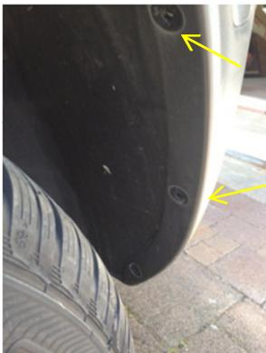
Nun die 3 Torxschrauben am Radlauf links und rechts rausdrehen:
