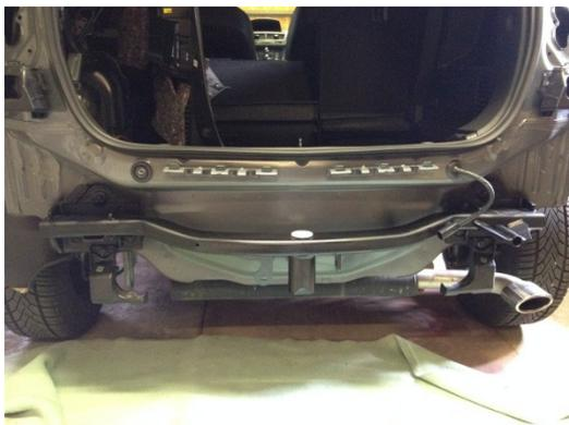
Die AHK anschrauben und mit Drehmomentschlüssel anziehen laut Anleitung.
