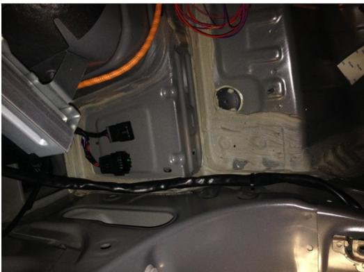
Innen wird das Kabel am Heckblech entlang verlegt und mit Kabelbindern befestigt.
