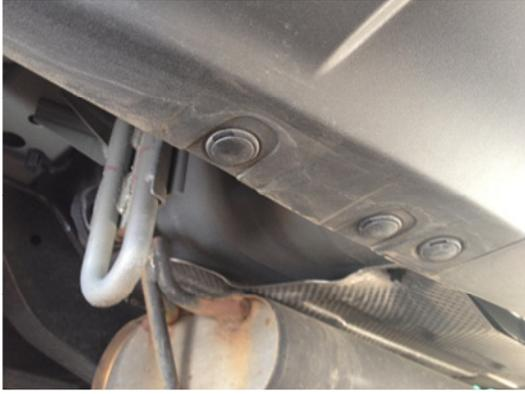
Nun die 2 äußeren Clipse mit Schlitzschraubenzieher rausdrücken, der innere kann bleiben.
