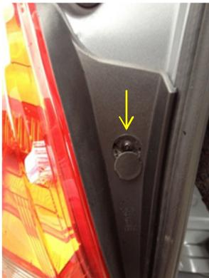
Außen ist noch 1 Kreuzschlitzschraube unter der kleinen Abdeckung, die muss auch raus, dann kann das Rücklicht abgenommen werden, den Stecker mit kleinem Schraubenzieher entriegeln.
