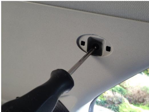
Nun an der linken C-Säule die kleine ovale Abdeckung rausdrücken, darunter wieder eine Kreuzschlitzschraube rausdrehen.
