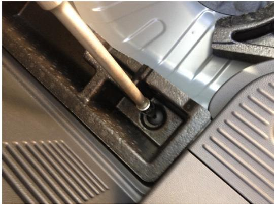
Zunächst die Abdeckungen oben und unten im Kofferraum rausnehmen. Der Einsatz unter der Abdeckung ist 2teilig und ist mit je 1 Torxschraube befestigt.
