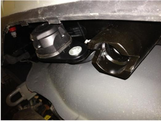
Vor Wiedermontage der Stoßstange die Steckdose anschließen und montieren. Danach kommt man nur schwer dran. Ich benutze dazu den Original Durchführungsgummi. Diesen mit Schraubenzieher durchstoßen und weiten bis ein Plastikrohr ca. 15mm durchpasst. Die Kabelenden in das Rohr schieben und dann das Rohr aus der Dichtung zurückziehen. Nun ist der relativ dicke Kabelstrang fest und dicht in dem Gummi. Habe leider keine Bilder davon gemacht.
