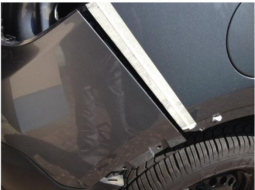
Wenn der Radlauf weg ist kann die Stoßstange am Kotflügel gelöst werden.
