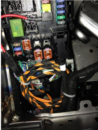
Das Kabel ist ziemlich lang, was übrig war habe ich mit Kabelbindern zusammengebunden und im Sicherungskasten fixiert.
