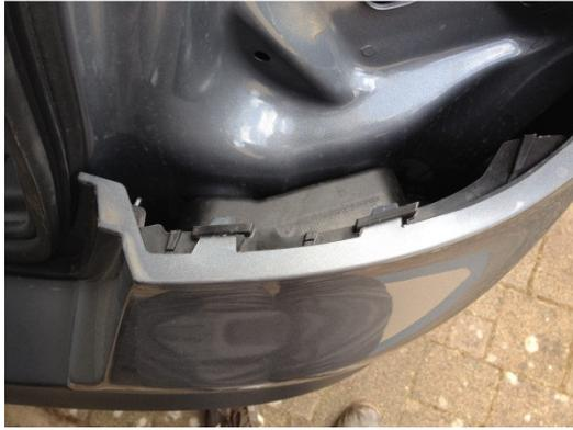
Unter dem Rücklicht auf jeder Seite 3 Clipse eindrücken und an der Stoßstange ziehen..... und ziehen..... dieses verflixte Ding will einfach nicht ab..... und keine Schrauben mehr die etwas festhalten
