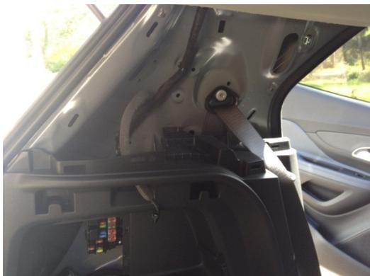
Jetzt die linke Verkleidung der C-Säule abziehen. Sie wird noch von 3 Klammern gehalten, die sind aber stabil, also einfach ziehen. Hier ist sie schon ab.
