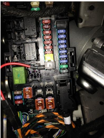
Die Pluskabel habe ich auf Sicherungsplatz F19 (Reserve) angeschlossen. Hier ist die Zeichnung in der Anleitung ungenau. Sie zeigt nicht den Sicherungskasten des Mokka sondern des Trax. Das Kabel muss nach links wegführen.
