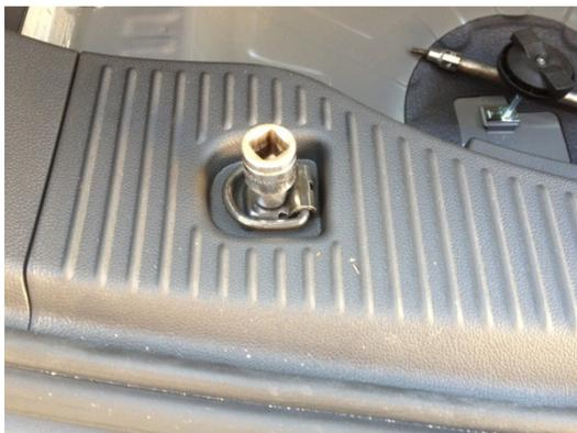
Dann die hintere Abdeckung losschrauben (10er Schlüssel) und die Zurrösen abnehmen. Die Abdeckung dann nach oben wegziehen. An der Seitenwand links ebenfalls die Verzurröse abschrauben.
