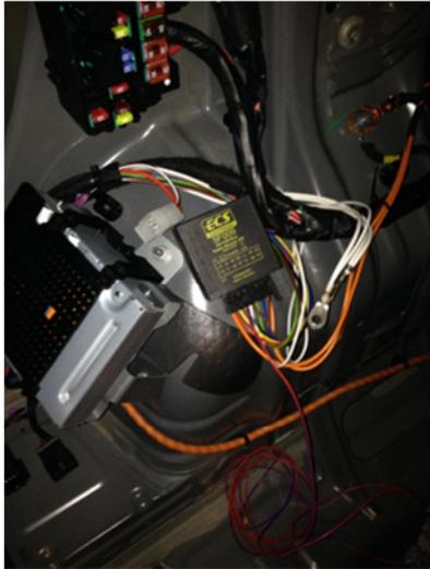
Steuergerät montieren, Masse anschließen und Bremslichtkabel anschließen, alles wie in der Anleitung beschreiben.
