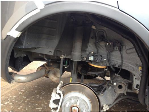
Unter den Radläufen rechts und links ist die Stoßstange noch mit je 2 Clipsen und 1 Schraube mit dem Radlauf verbunden.
