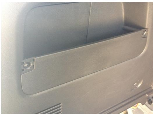
Die 2 kleinen Abdeckungen an der linken Seitenwand des Kofferraums mit kleinem Schraubenzieher rausdrücken, dann kommen 2 Kreuzschlitzschrauben zum Vorschein, diese rausdrehen und Verkleidung nach oben wegziehen.
