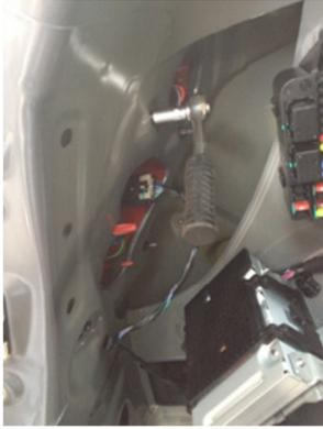
Jetzt 4 Muttern (SW8) des Rücklichts rausdrehen, für eine davon ist eine lange Nuss ratsam da der Führungstift ziemlich lange ist (wegen Platzierung beim Wiedereinbau). Ging aber auch mit der normalen Nuss und Zange, die Muttern sind relativ locker.
